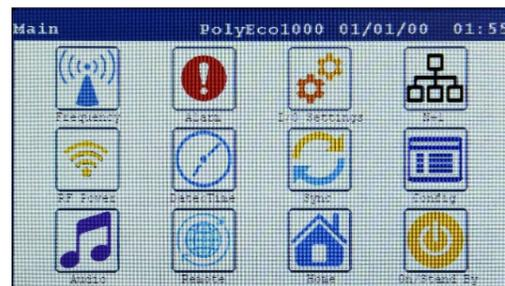
(4) Toque el icono **Frequency** (frecuencia) para ir a la pantalla **Frequency** (ajuste de frecuencia) donde la sección **On Air** (A) muestra la frecuencia corriente:
