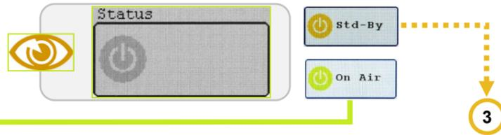
(2) Si el indicador Status muestra **On Air** tóquelo para poner el transmisor en espera. El indicador cambia a **Std-By**.
