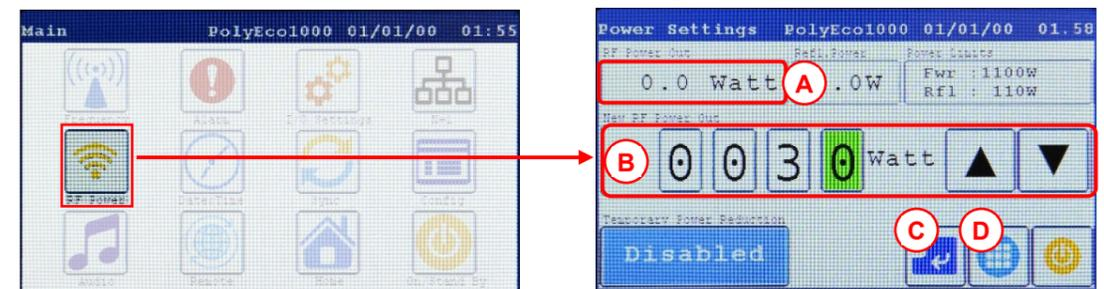
(7) En la sección **New RF Power Out** (B), Toque cada dígito de la potencia a variar y cámbielo con los botones **▲** y **▼**. Confirme el encendido con el icono (C) (Enter) y toque el icono (D) para volver a la pantalla **Main**.
