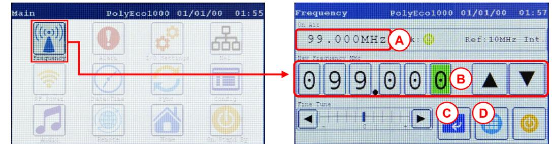
(5) En la sección **New Frequency MHz** (B), toque cada dígito de la potencia que desea cambiar y modifíquelo con los botones **▲** y **▼**. Confirme el encendido con el icono (C) (Enter) y toque el icono (D) para volver a la pantalla principal. **Main**.
